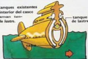
Con los tanques llenos, el submarino puede navegar bajo el agua.
