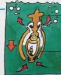
Para que el submarino se sumerja, los tanques de lastre deben llenarse de agua.
